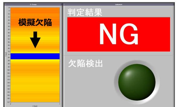
NAUT21-Sによる 検査結果画像(C-Scope)
